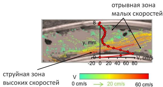
Ультразвуковая векторная визуализации поля скорости (f=500 к/с, не зависит от угла наклона датчика)
