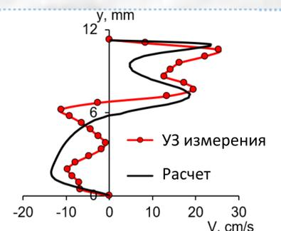
**ВЫВОДЫ.** Преимуществами нового метода ультразвуковой высокоскоростной векторной визуализации являются: независимость результата измерения поля скорости от угла наклона датчика, высокая скорость получения большого объема регистрируемых данных (500 к/с) о пульсирующем кровотоке в области сосудистого русла и возможность последующего многократного замедленного просмотра с целью обработки и анализа полученных данных.
