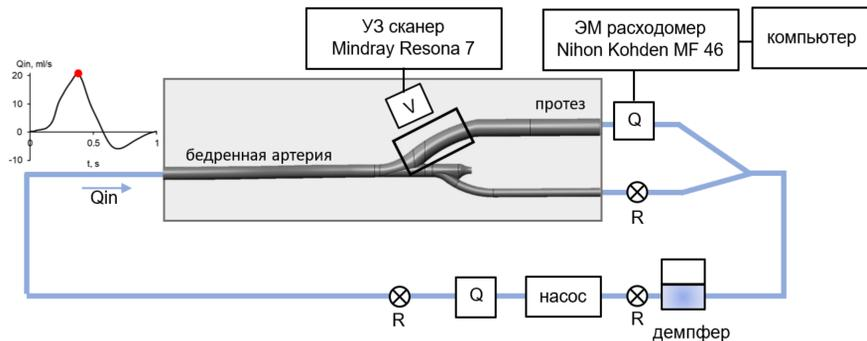
Q - датчик электромагнитного расходомера, R - регулятор расхода, V - ультразвуковой датчик
